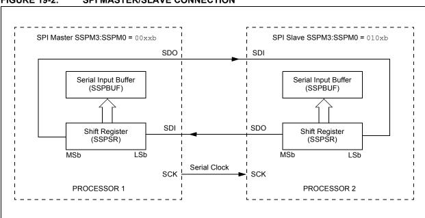
FIGURE 19-2: SPI MASTER/SLAVE CONNECTION
